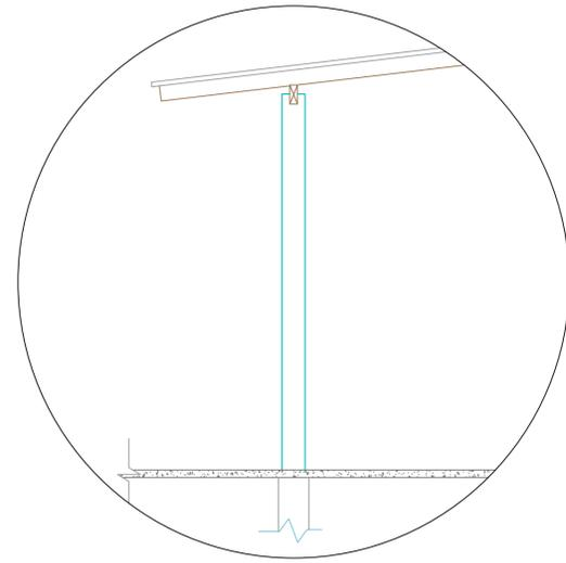
PILARES SEM FUNÇÃO ESTRUTURAL, SENDO APENAS PARA SUPORTE DE COBERTURA NA ÁREA FRONTAL.
