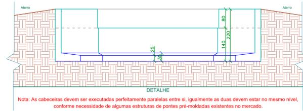
Nota: As cabeceiras devem ser executadas perfeitamente paralelas entre si, igualmente as duas devem estar no mesmo nível, conforme necessidade de algumas estruturas de pontes pré-moldadas existentes no mercado.
