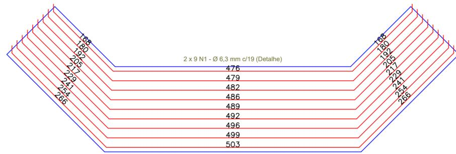
Detalhe do comprimento variável de cada barra
