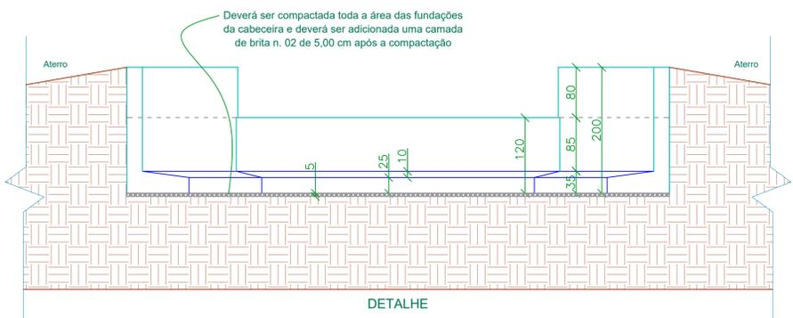
Nota: As cabeceiras devem ser executadas perfeitamente paralelas entre si, igualmente as duas devem estar no mesmo nível, conforme necessidade de algumas estruturas de pontes pré-moldadas existentes no mercado.
