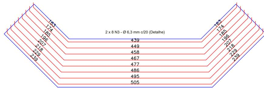
Detalhe do comprimento variável de cada barra
