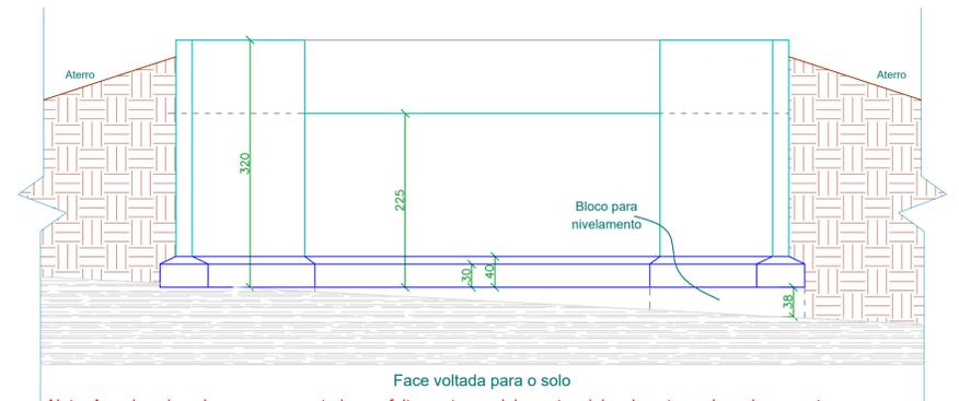
Nota: As cabeceiras devem ser executadas perfeitamente paralelas entre si, igualmente as duas devem estar no mesmo nível, conforme necessidade de algumas estruturas de pontes pré-moldadas existentes no mercado.
